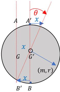
Déplacement d'un disque avec roulement sans glissement
