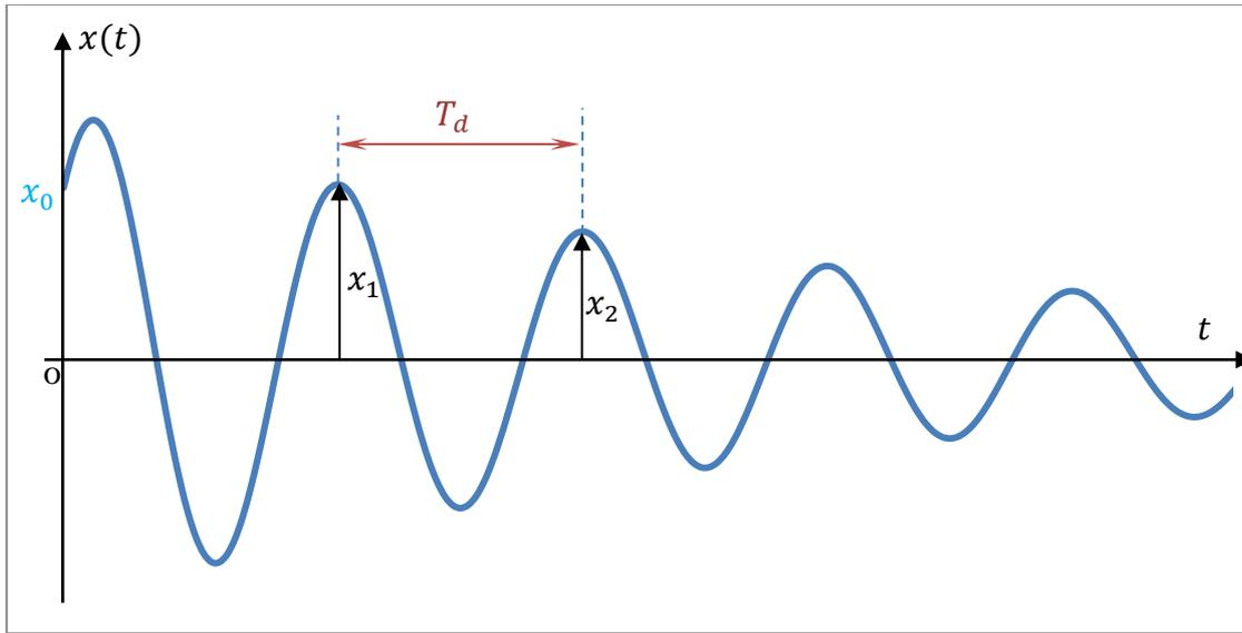
**Figure 2.4** - Réponse caractéristique d'un système sous-amorti
