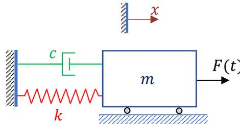
Figure 2.1 - Système masse-ressort-amortisseur
