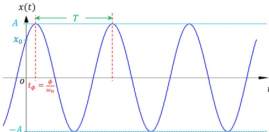
**Figure 2.2** – Réponse temporelle d'un système non amorti
