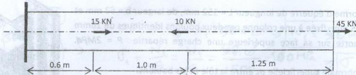
Ex3/ Soit une barre en acier dans laquelle est intercalée une barre en cuivre. Elle est exposée à un système de chargement axial. Tracer les diagrammes des efforts normaux, des contraintes et des allongements.
