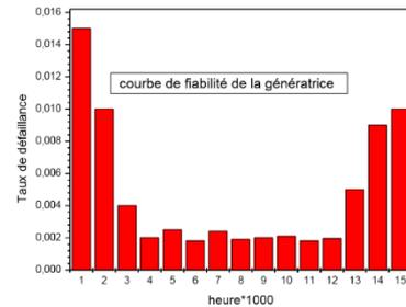
*Figure: Fiabilité de la génératrice et courbe en baignoire*
