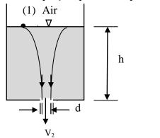
On applique le théorème de Bernoulli entre deux points (1) et (2) d'une même ligne de courant (surface libre et la sortie de l'orifice).
