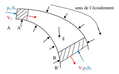
Soit un écoulement permanent de fluide incompressible. Considérons le système matériel formé par la partie du tube de courant entre les sections A et B au temps t. à l'instant t+dt, la même masse de fluide sera comprise entre les sections A' et B'.
