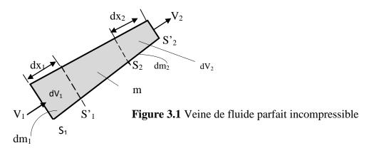
Considérons une veine de fluide incompressible de masse volumique  $\rho$  animé d'un écoulement permanent (Fig.3.1). On désigne par :
