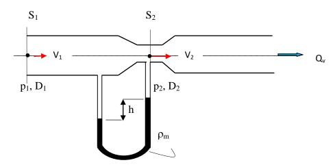
On appliquant le théorème de Bernoulli sur une ligne de courant entre les deux points (1) et (2), on obtient :
