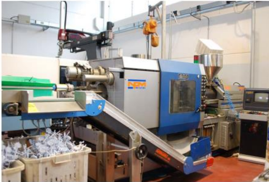
Figure II.2. Photo d'une presse d'injection industrielle.
