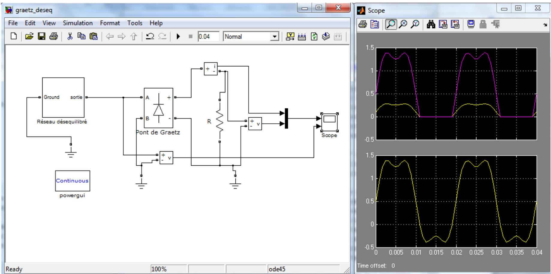
Le réseau déséquilibré avec une offset égale à 0.5 avec une harmonique d'ordre 3. L'analyse du spectre d'harmonique confirme le déséquilibre du réseau.
