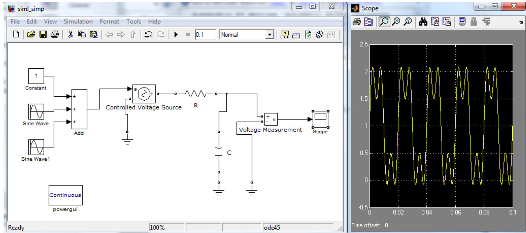
Cette méthode d'interfaçage, vous permet de modéliser un système avec des blocs Simulink puis lui ajouter un bloc de source à tension contrôlée (**Controlled Voltage Source block**) qui à la fin vous le rendez un sous système (**subsystem**), ainsi le système final obtenu pourra être incorporé dans un modèle crée en Simpowersystems.
