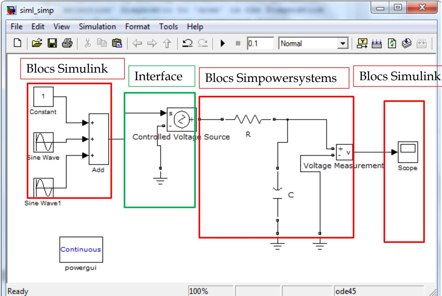
Le bloc source à tension contrôlée (**Controlled Voltage Source block**) pour injecter une tension dans un circuit électrique
