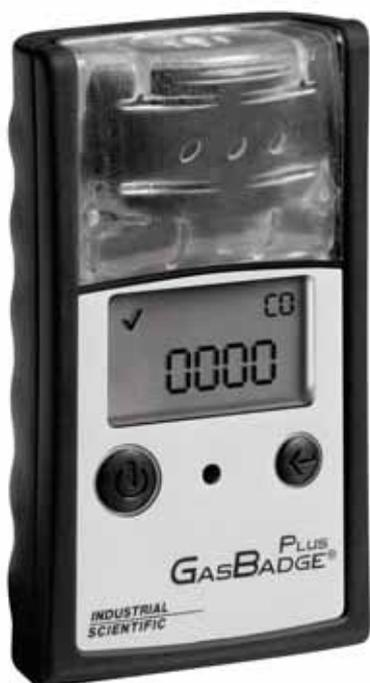
Le GasBadge® Plus est un détecteur portable mono-gaz sans entretien d'une durée de deux ans assurant une protection contre des concentrations dangereuses de monoxyde de carbone, de sulfure d'hydrogène, d'oxygène, d'oxyde d'azote ou de dioxyde de soufre. Le format compact et léger de l'appareil permet de le porter confortablement au moyen de différentes attaches. La cellule étant montée en partie supérieure, le GasBadge® Plus assure une protection continue, même lorsqu'il est mis dans une poche.
