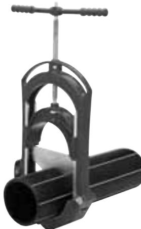
Porte-lame : assure le guidage de la lame perpendiculairement à l'axe du tube. Carré d'entraînement de 14 mm sur plats (modèle 1 et 2) et 17 mm (modèle 3). Permet l'utilisation d'une clé ou d'une douille à rallonge pour les coupes dans les tranchées profondes. Le crochet d'ouverture du V inférieur permet une mise en place à n'importe quel endroit du tube.
