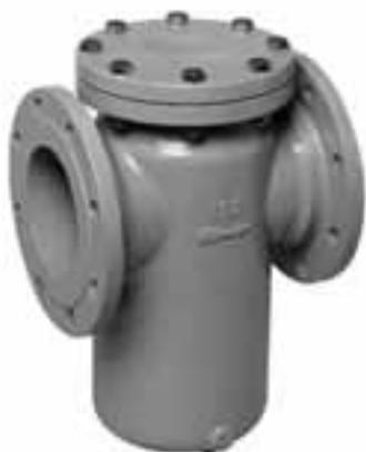
Les filtres sont disponibles du calibre 50 à 250 mm. Leur conception robuste et compacte permet une installation facile et durable dans des environnements difficiles. Le corps en fonte grise est protégée par une peinture epoxy et le tamis est en acier inoxydable.
