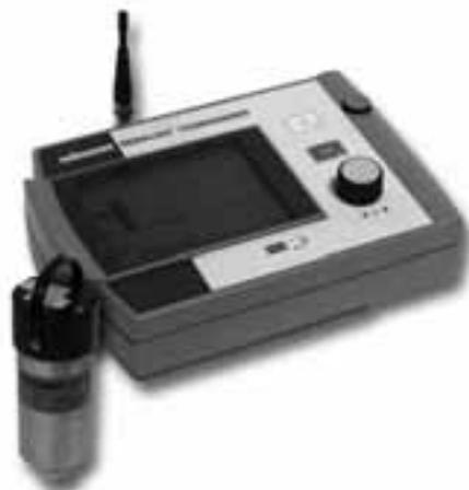
Sebalog® est un logger acoustique permanent, automatique et autonome, utilisé pour l'inspection de diagnostic de réseaux d'eau souterrains. On le place définitivement ou pour une période définie aux vannes de la zone à diagnostiquer.
