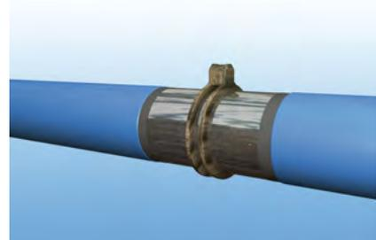
4. En fonction des conditions de soudage et du matériau des tubes utilisé, les extrémités des tubes doivent être préchauffées comme prescrit dans les instructions de soudage.
