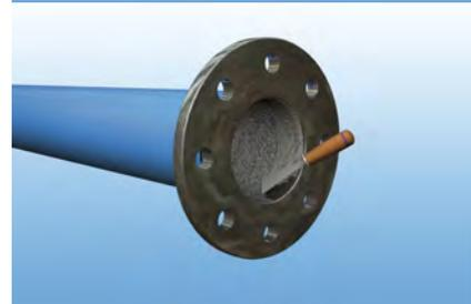
Afin d'assurer un durcissement approprié du revêtement, il est conseillé de recouvrir la surface revêtue de feuilles en matière plastique par exemple ou de maintenir la surface humide. Le mortier de ciment doit sécher pendant au moins 24 heures à cet endroit avant d'effectuer les travaux de soudage.
