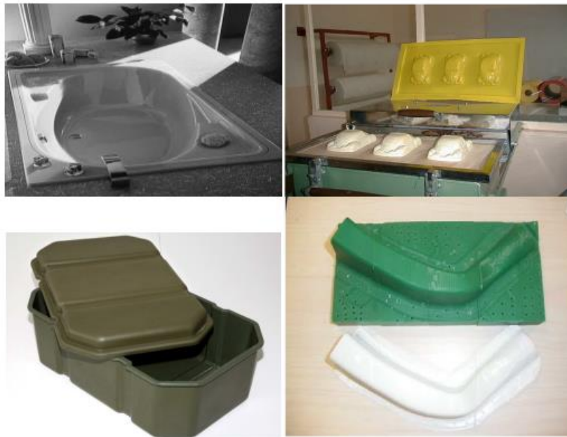
Figure III.5 : Produits thermoformés par thermoformage.
