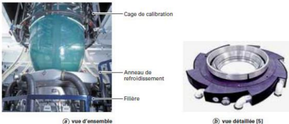
Figure VI.9: Anneau de refroidissement
