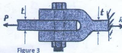
**Ex 4/** Deux barres chargées en traction par une force  $P$  sont assemblées en utilisant deux plaques rectangulaires et deux rivets.
