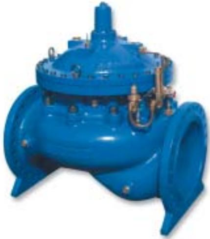
Les vannes de régulation série 700 BERMAD 24", 28", 30" et 32" sont des vannes à membrane, actionnées hydrauliquement, forme du corps en ligne. La vanne est composée de deux composants principaux : corps et actuateur. L'actuateur est démontable du corps en une seule pièce. Il est composé de deux chambres de contrôle – supérieure et inférieure. L'actuateur peut être configuré sur site à simple ou à double chambre suivant la fonction de régulation demandée.
