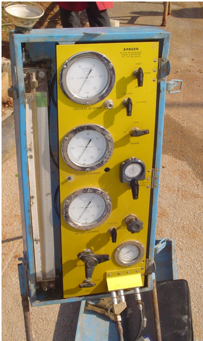
a) Contrôleur pression/volume (CPV)
