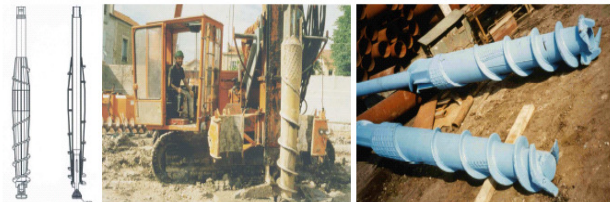
Figure 2-7 : Pieu vissé de type Oméga à deux pas de vis ou un seul [21]
