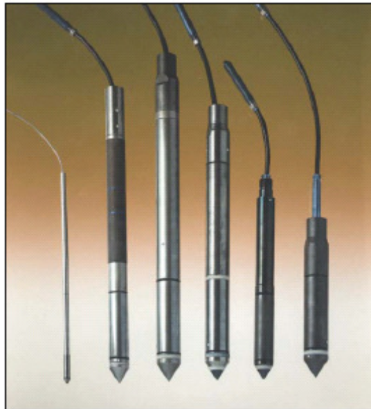
Figure III-3 : Photographie de cônes CPT (Doc. GEOMIL)
