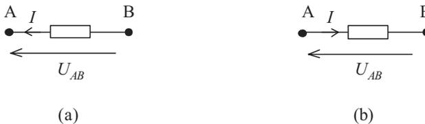
Figure 1.3 Convention générateur (a) et convention récepteur (b).
