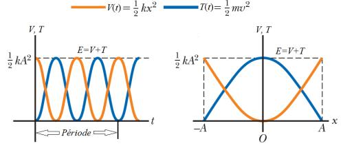
Pour de petites oscillations du système masse-ressort, l'énergie mécanique est constante comme on le voit avec le développement
